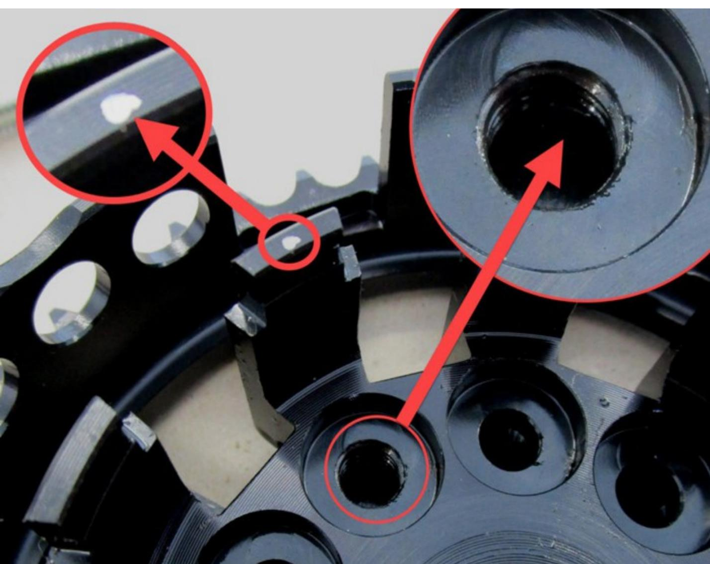
Dort werden die Schrauben zum Vorspannen der Grundplatte positioniert. Der Ausschnitt in der Zentrierhilfe gibt Flächen für die hohen Muttern frei, mit deren Hilfe die Kupplung für die Montage vorgespannt wird.
