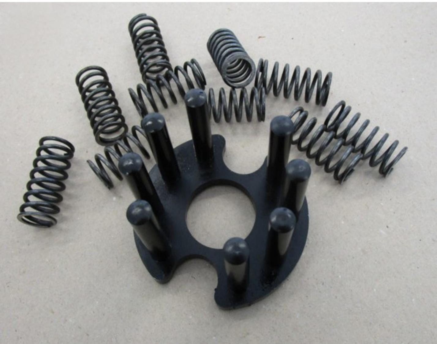
Die BGM Pro Superstrong für Lambretta verfügt bereits über ein integriertes Kupplungskompressor-System. Hierzu liegen der Kupplung zwei M8 Schrauben sowie zwei lange Muttern anbei. Auf der Stirnseite der Kupplungsspinne sind zwei der Beine mit einem Punkt markiert, an deren Grund sich die Gewindebohrung für die Schraube befindet.
